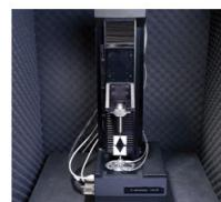
Systém NANO UTM T150 nabízí měření jak kvazi-statických, tak dynamických vlastností vzorků, které jsou malé nebo mají unikátní geometrii, příp. mikrovláken. Začleněním nanomechanických akčních čidel umožňuje testování jak velkých, tak malých napětí. Během testování velkých napětí čidla aplikují a snímají zatížení, zatímco je vzorek napínán křížovou hlavou. Z pohybu této hlavy je měřeno prodloužení.
